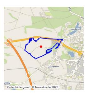
Bruchfeld der Grube Alt-Zscherben; 1864–1944; im Tiefbau ausgekohltes Feld; Flöz 2,5–3,5 m, Deckgebirge 6–45 m; die stärkeren Überdeckungen im Bereich des Hopp-Berges, sodass die Setzungserscheinungen nicht augenscheinlich sind; Ackerland.
