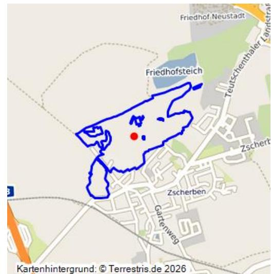
Abbaufeld der Königlich-Preußische Braunkohlengrube; 1807–1863; im Tiefbau ausgekohltes Feld; keine augenscheinlichen Setzungserscheinungen über den Bruchfeldern; Ackerland.
