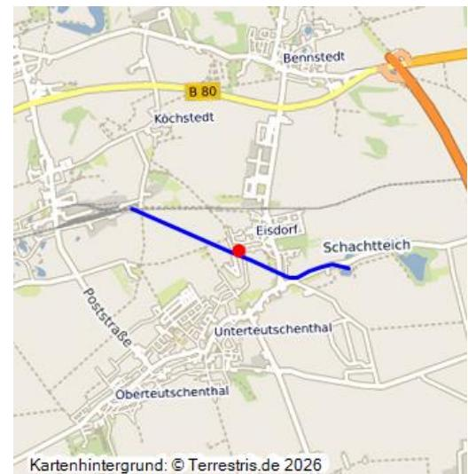
Seilbahn der Grube Henriette; vor 1903–1923; Trasse einer Luftseilbahn, vom Tagebau Grube Henriette zum Bahnhof Teutschenthal (1903 kartiert), auf einer Länge von 2800 m; 1909 Verlängerung der Streckenführung bis zur Schwelerei Löwendahl (40000384); Masten abgebaut, im Ackergelände keine Spuren sichtbar.
