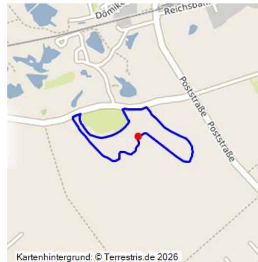
Bruchfeld der Grube Neu-Langenbogen; 1899–1921; im Tiefbau ausgekohltes Feld; Gelände über Bruchfeldern mit Setzungserscheinungen; Ackerland.
