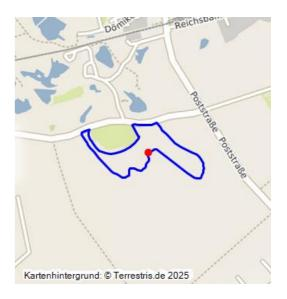
Bruchfeld der Grube Neu-Langenbogen; 1899–1921; im Tiefbau ausgekohltes Feld; Gelände über Bruchfeldern mit Setzungserscheinungen; Ackerland.
