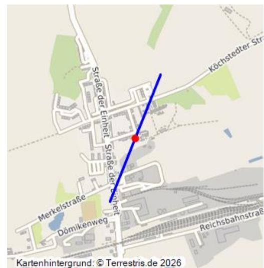
Seilbahn der Grube Pfännerschaft; 1874–1885; Seilbahntrasse, auf 740 m Länge, von der Grube (4000444) zur Fabrik mit Schwelerei; Masten abgebaut, Gelände durch dichte Bebauung gänzlich überformt.
