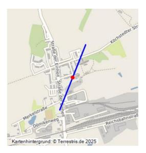
Seilbahn der Grube Pfännerschaft; 1874–1885; Seilbahntrasse, auf 740 m Länge, von der Grube (4000444) zur Fabrik mit Schwelerei; Masten abgebaut, Gelände durch dichte Bebauung gänzlich überformt.
