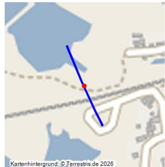
Abraumbahn der Königlichen Grube; bis 1835; Trasse einer Abraumbahn, von der Grube (40000430) zur Kippe (41000124) an dem hinteren Tömickenteich; ab 1828 mit Wagen auf Bohlenbelag, ab 1831 auf Schienen; Streckenführung nicht erhalten, Damm gestört; eventuell Reste auf der Kippe zu erwarten.
