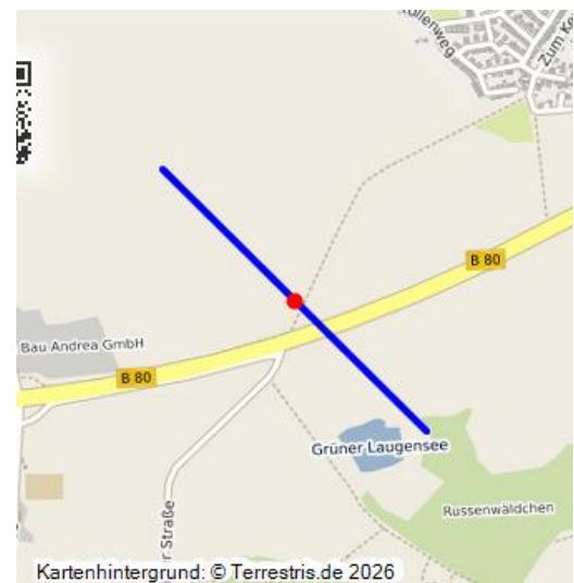
Seilbahn zur Schwelerei Löwendahl; nach 1882–1900; Trasse einer Seilbahn, zur Kohlelieferung von der Grube Seeberg zur Schwelerei Löwendahl; Masten abgebaut, Ackerland, keine Spuren im Gelände sichtbar.
