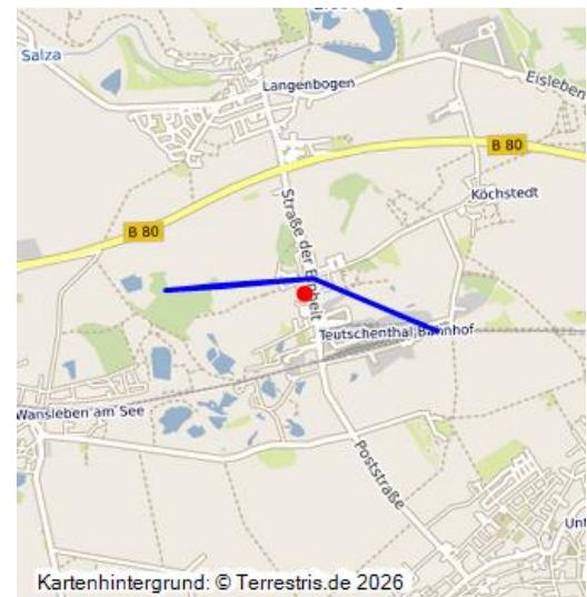
Seilbahn der Grube Henriette; 1909–1923; Trasse einer Luftseilbahn, vom Tagebau Grube Henriette bei Eisdorf zur Teerschwelerei Löwendahl; nach anfänglicher Streckenführung (40000453) bis zum Bahnhof Teutschenthal, 1909 Verlängerung der Seilbahn bis zur Schwelerei; Masten abgebaut, im Ackergelände keine Spuren sichtbar.
