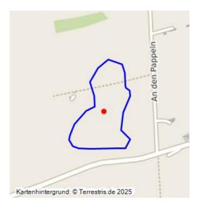
Abbaufeld mehrerer Tage- und Tiefbaugruben; vor 1851; im Tage- und Tiefbau ausgekohltes Feld mehrerer kleiner Privatgruben bei Holleben, Grube Nr. 36 und Nr. 227 Wilhelm-Franz; 1851 als "Brkgr" mit halbkreisförmiger Böschung kartiert; Senken durch Tiefbaugruben oder durch verschliffene Tagebaugruben hervorgerufen, im Luftbild Nachweise subrezenter Tagesbrüche; Ackerland, aktive Tagesbrüche.
