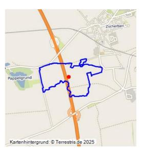
Abbaufeld der Schlettauer Gruben; 1838–1896; im Tiefbau ausgekohltes Feld; zusammenfassen als Schlettauer Gruben benannt, zugehörig drei Schächte (40000371); Gelände mit moderaten Setzungserscheinungen über Bruchfeldern; Ackerland.
