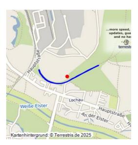
Abraumbahn in den ehemaligen Tagebau Lochau; Trasse einer Abraumbahn im ehemaligen Grubengelände Hermine-Henriette II/III; zwischen dem Tagebau Merseburg-Ost und dem Tagebau Lochau Nutzung bestehender Bahnstrecke Leuna-Ammendorf; ein Abschnitt des Gleiskörpers als Damm erhalten, als Fußweg genutzt; daneben herausgerissene Fundamente von Masten der elektrischen Oberleitung.
