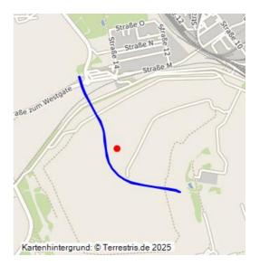
Anschlussbahn zur Fabrik Grube Pauline; nach 1898–1924; Werksbahn, Normalspur, von der Fabrik Pauline mit Anschluss an die Strecke Merseburg–Schafstädt; Gleise abgebaut, ehemaliger Bahndamm überackert, teils durch Straßenneubau gestört, große Abschnitte durch Spülkippe überdeckt, geringe Reste im digitalen Geländebild nachweisbar.
