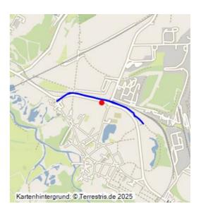
Feldbahn der Ziegelei Döllnitz; nach 1872-nach 1940; Strecke einer Grubenbahn, für Transport von Ton und Kohle; Gleise abgebaut, Damm auf ca. 70 m Länge erhalten, sonst durch Bahnstrecke Ammendorf-Leuna und Straßenneubau gestört.
