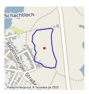
Tagebau der Königlichen Gruben; 1800-um 1850; im Tagbaubetrieb ausgekohlter Bereich; Tagebaugrube verfüllt, abgesenktes Geländeniveau; im Kartenwerk 1851 sind Tagebaue als drei durch Stege abgetrennten Gruben dargestellt, mit Wasserstand darin; Bergbaufolgelandschaft 1851 als "der königliche Teich", 1872 als "Kohlwiese" benannt; nach Bodenauffüllung im späten 19. Jh. rekultiviert, heute Ackerland, teils mit Kleingärten überbaut.
