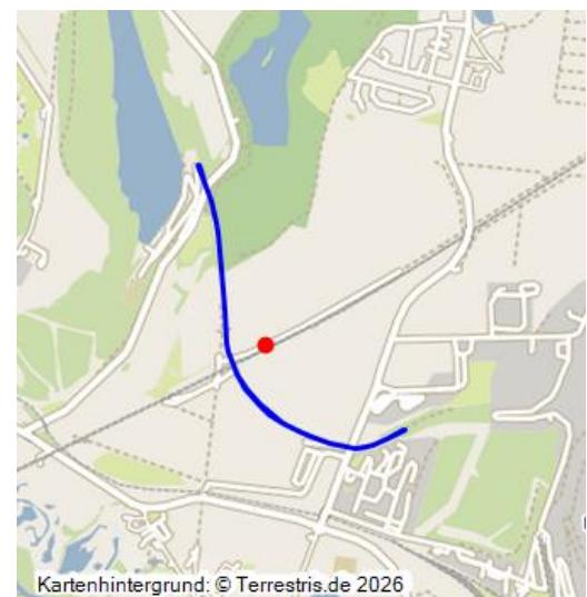
Kohlebahn zwischen Bruckdorf und Großtagebau Lochau; nach 1950–vor 1983; normalspurige Eisenbahntrasse; Gleise abgebaut, Teilabschnitt durch ICE-Bahnstrecke gestört, sonst Bahnkörper als Damm erhalten, bewachsen.
