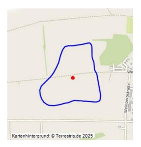
Abbaufeld von Grube Nr. 14 und anderen; 1738–1881; im Tiefbau ausgekohltes Grubenfeld der Grube Nr. 14 und vermutliche weiteren; Senken durch Setzungserscheinungen der Bruchfelder hervorgerufen; Ackerland.
