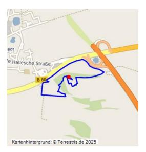
Älteres Abbaufeld der Grube Sophie; um 1850–ca. 1880; vermutlich im Tiefbau ausgekohltes Feld; Rekonstruktion nach Indizien im digitalen Geländemodell; Ackerland und nordwestliche Hänge des Hopp-Berges mit ehemaligen Obstbestand.
