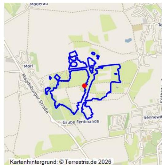
Abbaufeld der Grube Ferdinande; 1858–1932; im Tiefbaubetrieb ausgekohltes Feld; gesamter Abbaubereich der Grube, Förderung bis aus 35 m Tiefe; Bruchfeld bildet sich im Gelände durch moderate Senkungserscheinungen ab; Acker- und Wiesenland, bewaldete Hanglagen.
