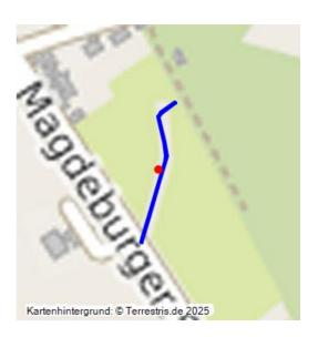
Abzugsgraben der Grube Ferdinande; 1845–1932; Graben zur Ableitung von dem in einer Rösche (Wasserstollen) gesammelten Grubenwasser; Austritt am südlichen Fuß des Götschberges; Wasserführung aktiv, mit auffällig ockerbraunem Wasser.
