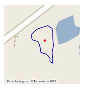
Kippe mit Abraum aus einem Tagebauaufschluss; nach 1909-vor 1940; Schüttung mit Bodenmaterial aus unbekanntem, nicht weitergeführten Tagebauversuch, oder Abraum aus Erschließungsarbeiten für Kiesabbau; flache Geländeerhebung mit militärischen Strukturen des Zweiten Weltkriegs, heute mit Gras, Gebüsch und Bäumen bewachsen.
