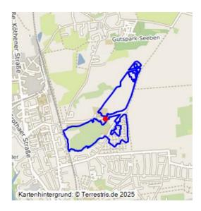
Abbaufeld der Grube Carl Ernst; 1849–1958; im Tiefbau ausgekohltes Feld; Bruchfeld, Gelände mit Setzungserscheinungen, Ackerland; in bewaldeten Gebieten Erhaltung subrezenter Tagesbrüche, teils als BMX-Trail genutzt.
