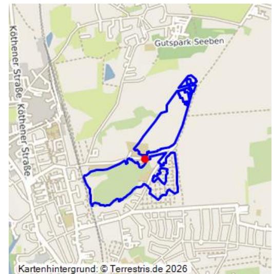
Abbaufeld der Grube Carl Ernst; 1849–1958; im Tiefbau ausgekohltes Feld; Bruchfeld, Gelände mit Setzungserscheinungen, Ackerland; in bewaldeten Gebieten Erhaltung subrezenter Tagesbrüche, teils als BMX-Trail genutzt.
