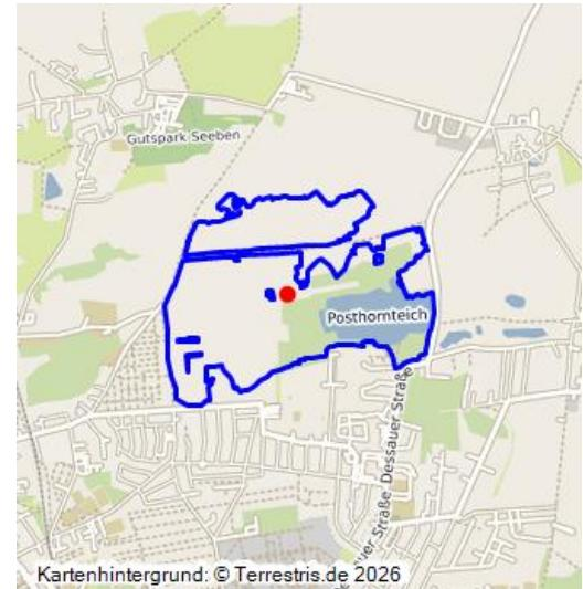
Abbaufeld der Grube Carl Ernst; 1885–1957; im Tiefbau ausgekohltes Feld, 1910 Vereinigung mit restlichen Abbaufeldern der Grube Glückauf; Bruchfeld, Gelände mit merklichen Setzungsscheinungen; Ackerland und Kleingartenanlagen „Frohe Zukunft“.
