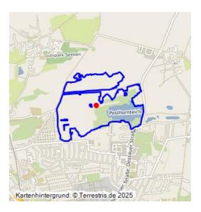
Abbaufeld der Grube Carl Ernst; 1885–1957; im Tiefbau ausgekohltes Feld, 1910 Vereinigung mit restlichen Abbaufeldern der Grube Glückauf; Bruchfeld, Gelände mit merklichen Setzungserscheinungen; Ackerland und Kleingartenanlagen "Frohe Zukunft".
