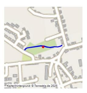
Rösche (Wasserstollen) der Grube Glückauf; nach 1852–1910; Abzugsgraben; Weiterleitung des stark eisenhaltigen Grubenwassers aus dem Tiefbau der Grube Glückauf (40000157); Graben später abschnittsweise verlegt und nachgezogen, dadurch überprägt; alter Graben stellenweise trocken, neuer Graben mit aktiver Wasserführung.
