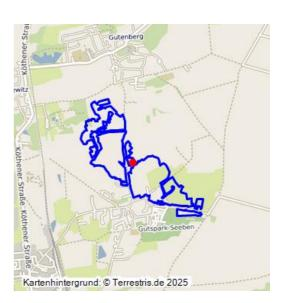
Abbaufeld der konsolidierten Grube Glückauf; nach 1874–1910; im Tiefbaubetrieb ausgekohltes Feld; das Bruchfeld umfasst die Abbaue der konsolidierten Gruben Glückauf, Fridolin, Zur Hoffnung und Vereinigung; kaum wahrnehmbare Senkungserscheinungen im Gelände; Wiesen- und Ackerland.
