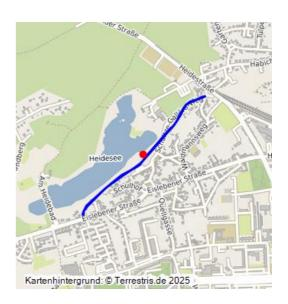
Eisenbahnanschluss zwischen Zementfabrik Portlandzementwerke "Saale" AG (40000145), Grube "Neuglück" (40000049) und Bahnhof Nietleben (40000535), mit dem Beginn der Zementfabrik: um 1910; entlang des Fußweges am Heidesee gut bis stellenweise sehr gut erhalten (Schienen mit Schwellen und Schotter, Schilder und Signalanlagen).
