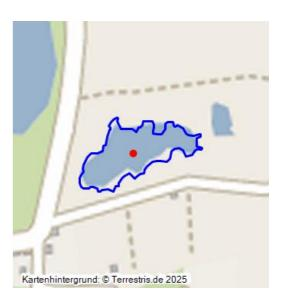
Durch Einsturz des Stollensystems der Tiefbaugrube Frohe Zukunft entstandene Senke, die sich mit dem hoch anstehenden Grundwasser füllte, besonders nachdem ab 1961 die für die Kohleförderung erforderliche Absenkung des Grundwasserspiegels eingestellt wurde; Wasserfläche von 5 ha, die ungewöhnlich flache Wassertiefe von nur 2 m beeinträchtigt die Wasserqualität; rund um den Teich Verlandungszonen und Nasswiesen; der Name Posthorn leitete sich vom nahen Gasthaus ab.
