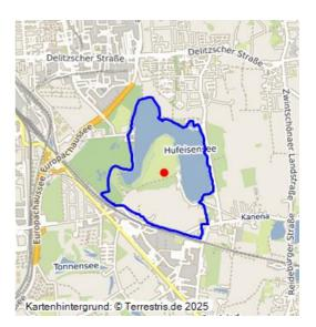
Tagebau Bruckdorf Nord; 1925–1945; im Tagebaubetrieb ausgekohltes Feld; Grube des Bruckdorf-Nietlebener Bergbau-Vereins, ab 1939 IG Farben; Tagebaugrube mit Innenkippe verfüllt, U-förmiges Tagebaurestloch mit Wasser gefüllt, sogenannter Hufeisensee (40000118), sonst rekultiviert und aufgeforstet.
