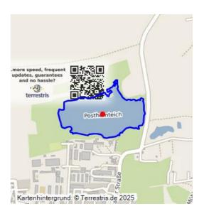
Durch Einsturz des Stollensystems der Tiefbaugrube Frohe Zukunft entstandene Senke, die sich mit dem hoch anstehenden Grundwasser füllte, besonders nachdem ab 1961 die für die Kohleförderung erforderliche Absenkung des Grundwasserspiegels eingestellt wurde; Wasserfläche von 20 ha, die ungewöhnlich flache Wassertiefe von nur 2 m beeinträchtigt die Wasserqualität; rund um den Teich Verlandungszonen und Nasswiesen; der Name Posthorn leitete sich vom nahen Gasthaus ab.
