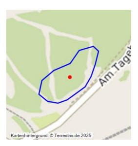
Abfallhalde der Fabriken Grube Hermine-Henriette I; nach 1906–1928; Aschehalde der Schwelerei, Mineralöl- und Brikettfabrik; als Deponie im ehemaligen Tagebaugelände, auf einer Grundfläche von ca. 100 x 50 m, Schüttung mit Asche und anderen teerhaltigen Prozessrückständen; heute bewaldet, an steilen Böschungen einzelne Blößen mit Oberflächenfunden.
