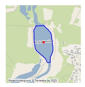
Die südlich der Talsperre Spremberg gelegene Vorsperre Bühlow dient neben dem Ausgleich von Wasserspiegelschwankungen im Stauwurzelbereich und dem Rückhalt von Geschiebe insbesondere dem Rückhalt der Eisenhydroxide zum Schutz des Biosphärenreservats Spreewald.
