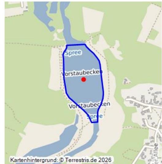
Die südlich der Talsperre Spremberg gelegene Vorsperre Bühlow dient neben dem Ausgleich von Wasserspiegelschwankungen im Stauwurzelbereich und dem Rückhalt von Geschiebe insbesondere dem Rückhalt der Eisenhydroxide zum Schutz des Biosphärenreservats Spreewald.
