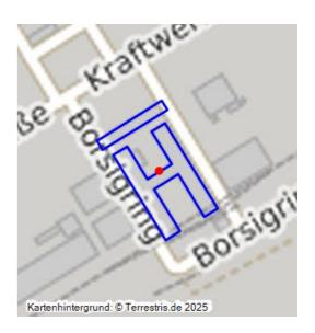
Die Hauptwerkstatt des Kraftwerks Vetschau besteht aus einer H-förmigen Werkstatthalle und einem quergestellten Hauptgebäude, die heute noch erhalten sind. Hier wurden technische Reparaturen und Instandhaltungsarbeiten durchgeführt, um die Funktionsfähigkeit und Leistungsfähigkeit der Kraftwerkanlagen zu gewährleisten.
