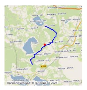
Der Verlauf des Buchholzer Fließes wurde Mitte der 1960er Jahre vom Tagebau Greifenhain unterbrochen. Als Ersatz wurde ein Graben angelegt, der das Wasser im Süden und Osten um den Tagebau führt. In Casel mündet das Neue Buchholzer Fließ wieder in den ursprünglichen Lauf.
