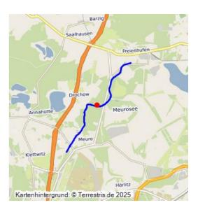
Über den Meuroer Graben werden die Westmarkscheide (Objektnr. 32003189) und der Marienteich (Objektnr. 32001453) in Richtung Pößnitz und Grubenwasserreinigungsanlage Pößnitz (Objektnr. 32001896) entwässert.
