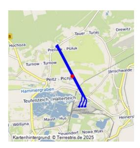
Über die Freileitung mit einer Länge von 10,66 km wird 380-kV-Strom aus dem Kraftwerk Jänschwalde dem Umspannwerk Preilack zugeführt und dort in das Höchtspannungsübertragungsnetz eingespeist.
