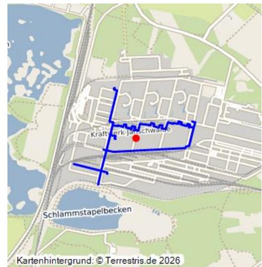
Über die oberirdische Fernwärmeverteilung werden Funktionsbereiche und Gebäude auf dem Kraftwerksgelände mit thermischer Energie versorgt, die durch die Kraft-Wärme-Kopplung im Kraftwerk entsteht. Aus den Turbinen gelangt über ein geschlossenes Rohrleitungssystem erhitztes Wasser zu den Abnahmestellen, das nach Nutzung innerhalb des geschlossenen Fernwärmekreislaufs zum Kraftwerksstandort zurückgeführt wird.
