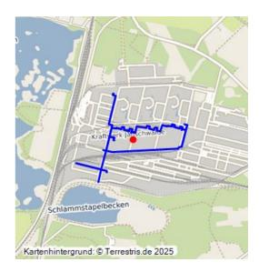
Über die oberirdische Fernwärmeverteilung werden Funktionsbereiche und Gebäude auf dem Kraftwerkgelände mit thermischer Energie versorgt, die durch die Kraft-Wärme-Kopplung im Kraftwerk entsteht. Aus den Turbinen gelangt über ein geschlossenes Rohrleitungssystem erhitztes Wasser zu den Abnahmestellen, das nach Nutzung innerhalb des geschlossenen Fernwärmekreislaufs zum Kraftwerksstandort zurückgeführt wird.
