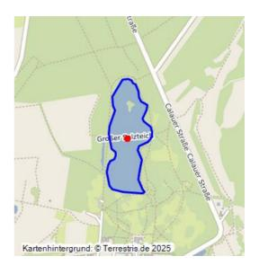
Das Grubenwasser aus dem Tagebau Greifenhain (Objeknr. 32003005) wurde ab 1965 über den Salzteich Altdöbern in das Neue Vetschauer Mühlenfließ (Objektnr. 32003011) geleitet. Der Salzteich diente als Absetzbecken, bevor das Grubenwasser über das neu angelegte Fließ bis zur Grubenwasserreinigungsanlage Vetschau transportiert wurde.
