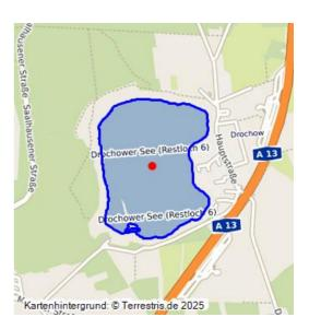
Das aufgrund der Braunkohleförderung des Tagebaus Waidmannsheil (Betriebszeit 1885-1941) entstandene, ca. 50 m tiefe Restloch füllte sich im Anschluss mit Grundwasser. Wegen Rutschungsgefahr erfolgten von 1998 bis 2006 Sanierungsarbeiten durch die LMBV. So wurden die gesamten Kippenböschungen durch die Herstellung eines Stützdamms durch Rütteldruckverdichtungen und mittels Wasserbausteinen gesichert und ein Wirtschaftsweg, der auch für die Naherholung genutzt werden kann, angelegt.
