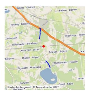
Die fragmentarisch erhaltene Wasserleitung zur Flutung des Gräbendorfer Sees ging am 15.03.1995 in Betrieb. In der Grubenwasserreinigungsanlage Vetschau aufbereitetes Wasser wurde über die Rohrleitung mit etwa 1,20 m Durchmesser zum nordöstlichen Randbereich des ehemaligen Tagebau Gräbendorf geführt und eingeleitet.
