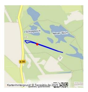
Die Rampe diente zum Transport der Kohlen über eine Werkbahn aus der Grube Karl-Marx (Betriebszeit 1947-1949) zu einer Verladung mit Siebanlage. Relikte der Verladeeinrichtung sind nahe der heutigen B 96 noch vorhanden (Objektnr. 32002883).
