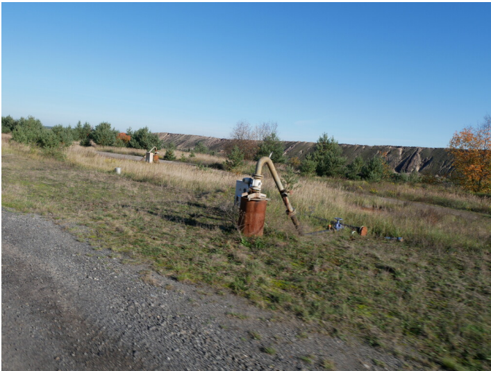
Vorfeldentwässerung Tagebau Jänschwalde Fotograf/Urheber: Stefan Krug
