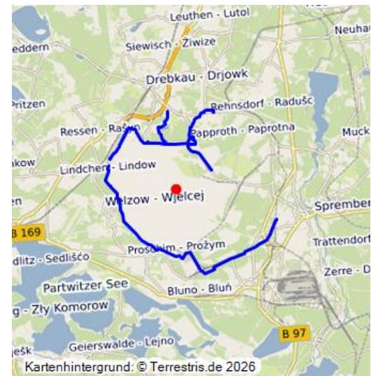
Die Grubenwasserbehandlungsanlage Am Weinberg stellt über das Rohrsystem sogenanntes Ökowasser bereit. Mit diesem Wasser werden Gewässer, die durch die Absenkung des Grundwasserspiegels gefährdet sind bzw. deren Quellgebiet vom Tagebau in Anspruch genommen wurden, gestützt.
