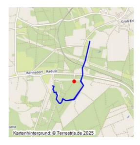
Der Döbberner Graben wird als Rekultivierungsmaßnahme mit Wasser aus der Grubenwasserbehandlungsanlage Am Weinberg gestützt. Die Einleitmengen betragen zwischen Mai und Oktober 3 m³/min, zwischen November und April 2 m³/min.
