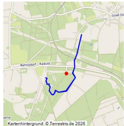
Der Döbberner Graben wird als Rekultivierungsmaßnahme mit Wasser aus der Grubenwasserbehandlungsanlage Am Weinberg gestützt. Die Einleitmengen betragen zwischen Mai und Oktober 3 m<sup>3</sup>/min, zwischen November und April 2 m<sup>3</sup>/min.
