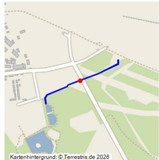
Die Teichgruppe Haidemühl und der Zollhausteich werden mit Wasser aus den Randriegeln des Tagebaus Welzow-Süd versorgt. Damit wird ein Trockenfallen der Teiche aufgrund der Grundwasserabsenkung des Tagebaus verhindert.
