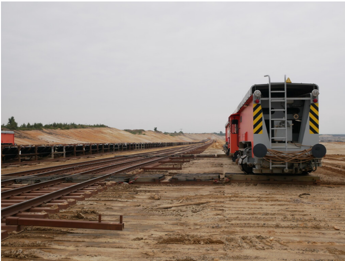
Schienenstränge für Vorschnittbagger Es 3150 1285 Fotograf/Urheber: Franz Dietzmann
