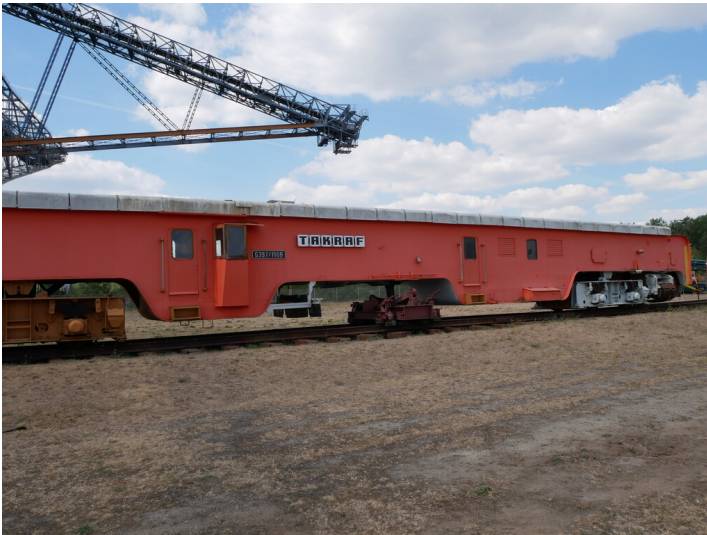
Gleisrückmaschine R 1435 DEQR Fotograf/Urheber: Kaja Boelcke
