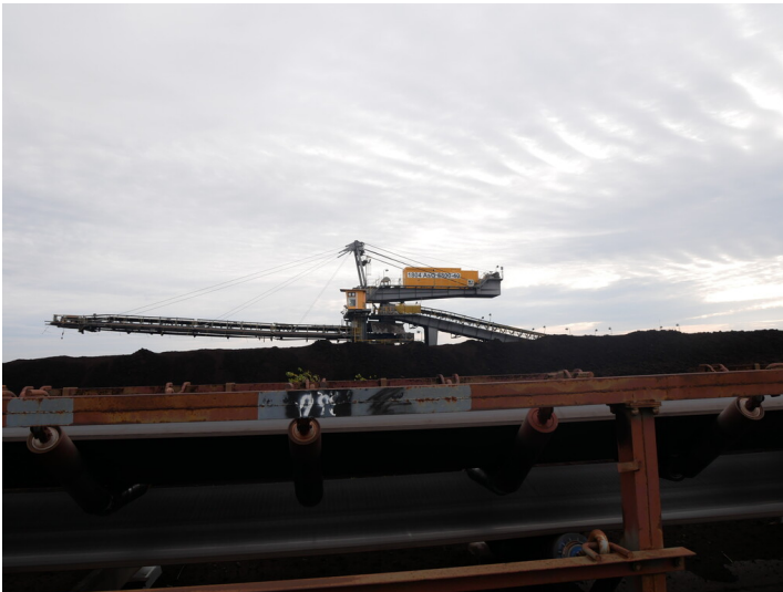
Haldenschüttgerät As-G 8800.40/ 1804 Fotograf/Urheber: Tanja Trittel
