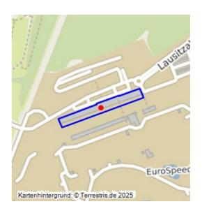
Um Standsicherheit für die neu zu errichtenden Gebäude des Lausitzrings zu gewährleisten, fanden Rütteldruckverdichtungen auf dem für die Bebauung vorgesehenen Areal des Kippengeländes des Tagebaus Meuro statt.
