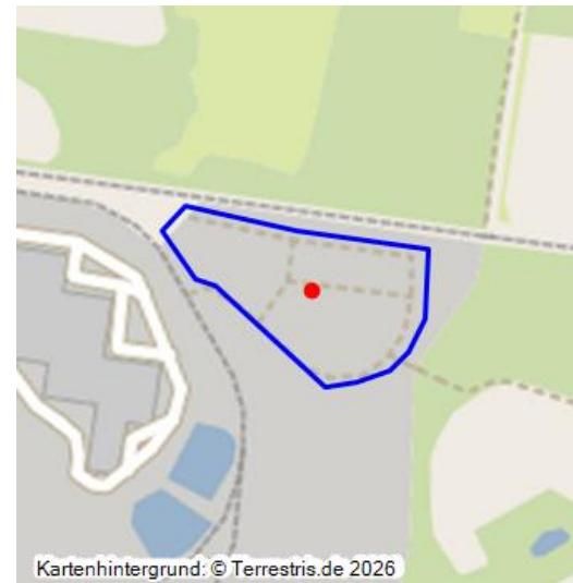
Die Wasserbehandlungsanlage Eichow wurde 2014 in Betrieb genommen. Sie dient der Reinigung des Eichower Fließes von Eisenhydroxidschlamm. Das stark eisenhaltige Wasser des Fließes wird vor der Einmündung in das Greifenhainer Fließ über die drei Absetzbecken der Anlage geleitet und kann dort einen Großteil der Eisenfracht absetzen.
