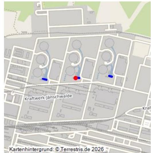
Die Kühlwasserpumpstation dient der Zuführung von Kühlwasser in den Wasser-Dampf-Kreislauf. Kühlungswasserressourcen stellen die Sümpfungswasser aus den Tagebauen Jänschwalde und Cottbus-Nord dar, das in Reinigungsanlagen aufbereitet wird.
