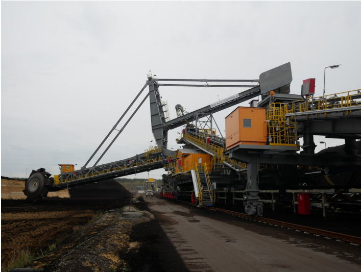
Kombiniertes Schaufelrad-Haldenschütt/-rückladegerät Fotograf/Urheber: Tanja Trittel
