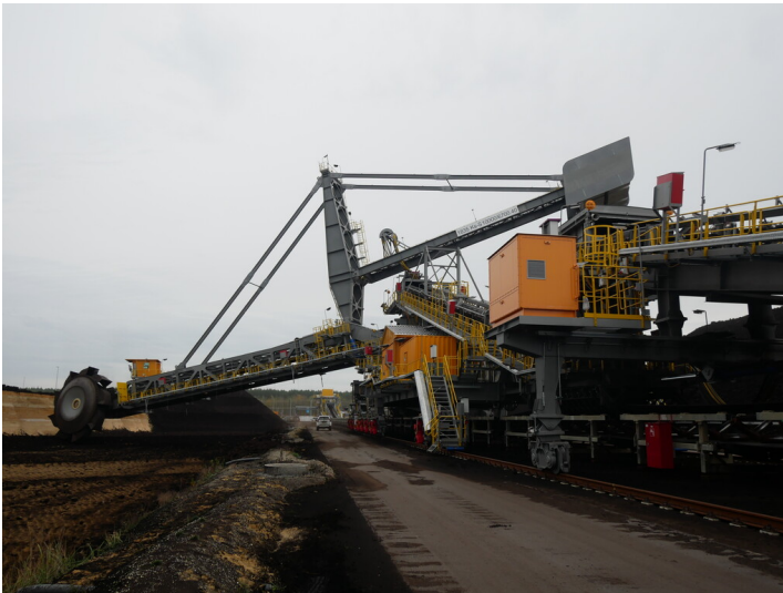
Kombiniertes Schaufelrad-Haldenschütt/-rückladegerät Fotograf/Urheber: Tanja Trittel
